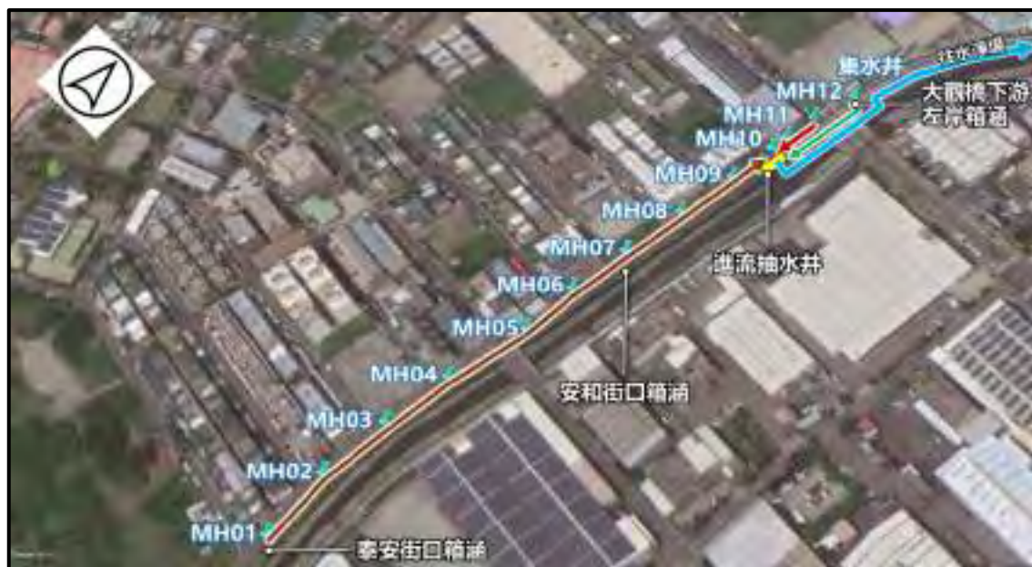
圖25、民生污水截流平面配置圖
