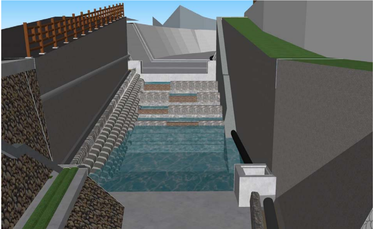
圖 3-11 固床工矮化模擬示意圖
