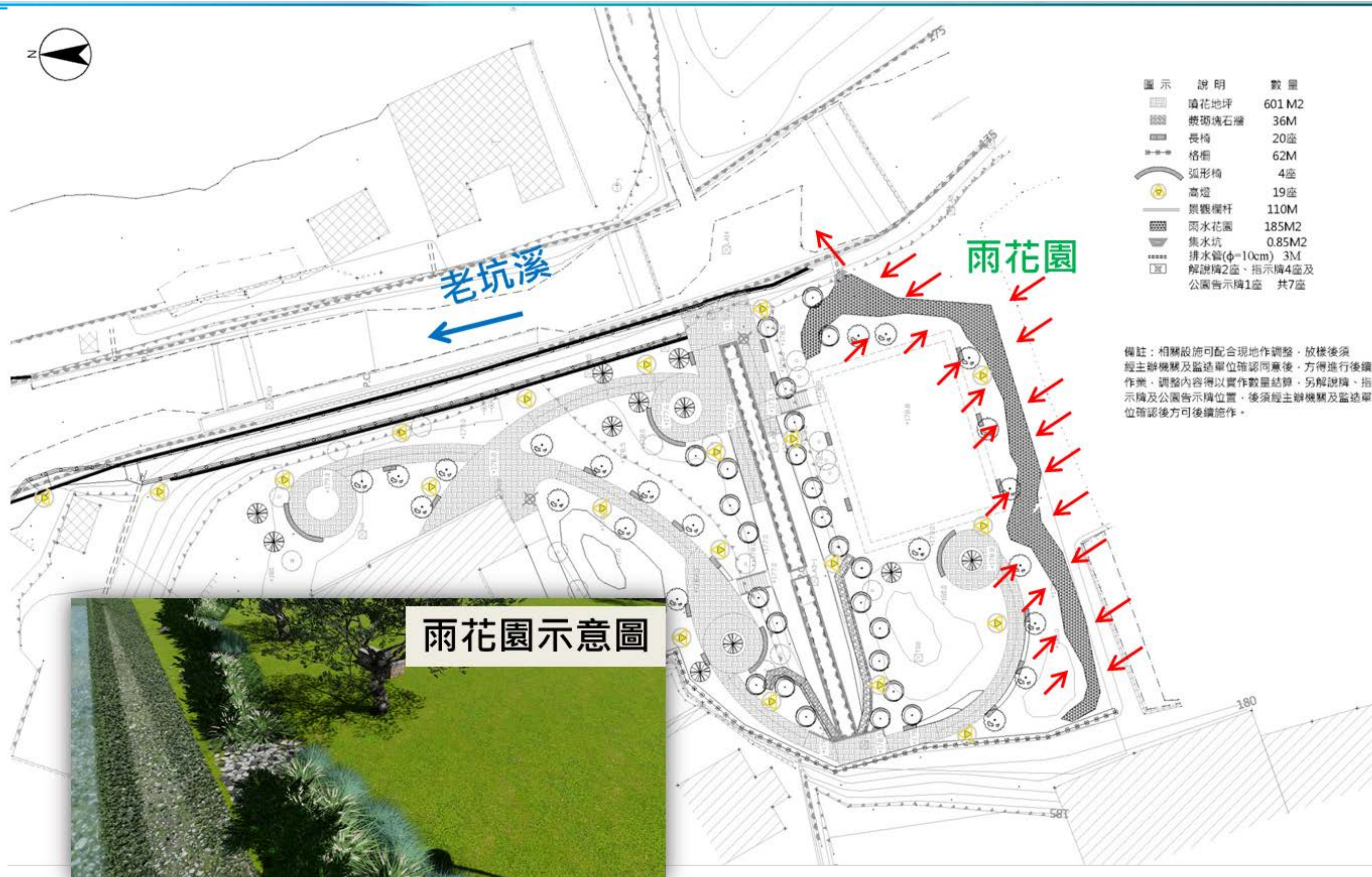
圖 4.3 排水設施配置圖(一)
